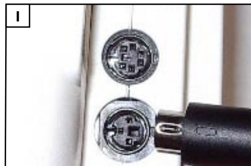
Tilslutning af oximeteret til modulet DV5M SmartLink.
