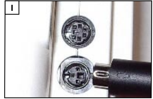
Σύνδεση του Οξύμετρου με το 9054 RPM-AutoAdjust
