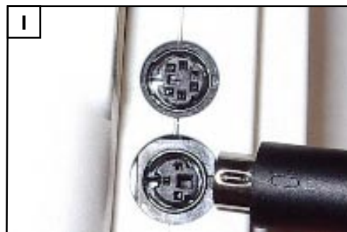
Conexión del oxímetro al módulo DV5M SmartLink.
