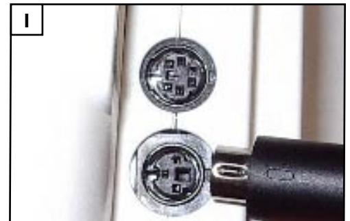
Oksimetrin yhdistäminen mallin DV5M SmartLink-moduuliin
