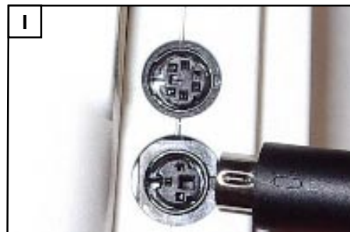
Koble oksimetret til DV5M SmartLink-modulen.
